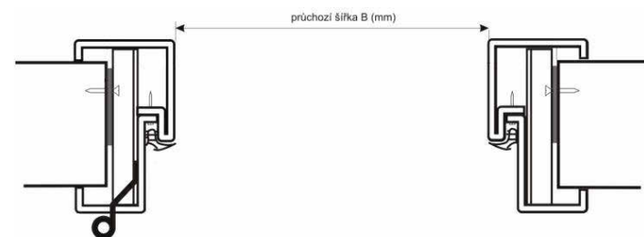
SCHEMA OBLOŽKOVÉ ZÁRUBNĚ
